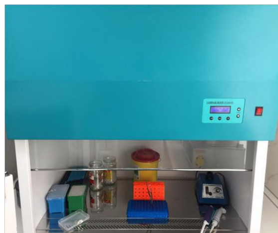
دستگاه هود بیولوژیک کلاس II برای استخراج DNA
